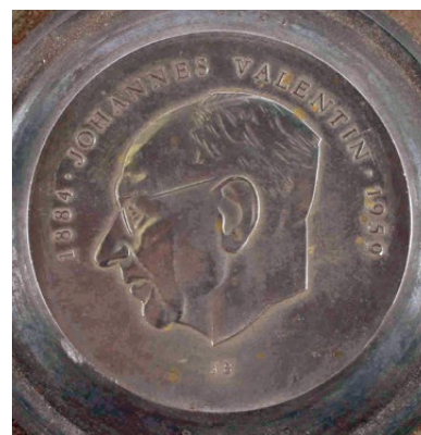
Abbildung 4: Die Patrize in erhabenem Relief (Inv.-Nr. VII D 0450.2) mit Umschrift dient als Vorlage für den eigentlichen Prägestempel, in dem Bild und Schrift wieder eingetieft sind.
